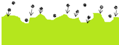
Figura 6 (Desgaste por Erosión) (12)
