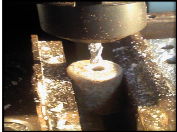
Fig. 12. Maquinado de bujes de 1 Pulg. En PET reciclado.(Fuente: Lab. De Manufactura del ITSSAT).
