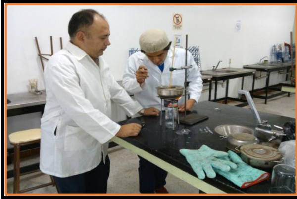
Fig. 11. Fundiendo PET a 260°C. En Lab.Quimica en el ITSSAT. (Fuente Propia).
