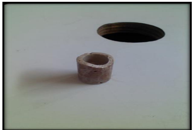
Fig. 13. Bujes de 1 pulgada maquinado en equipo CNC del Instituto Tecnológico Superior de San Andrés Tuxtla.
