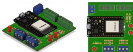
Figura 18 Vista 3D del circuito impreso para el cronómetro y sensores
