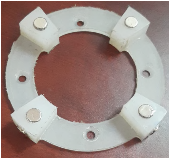
Figura 9 Aro lector del árbol de levas con imanes incrustados
