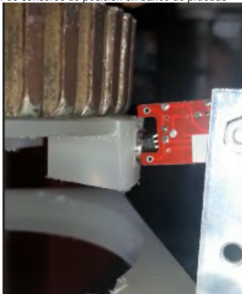
Figura 13 Calibración de sensores de posición en banco de pruebas
