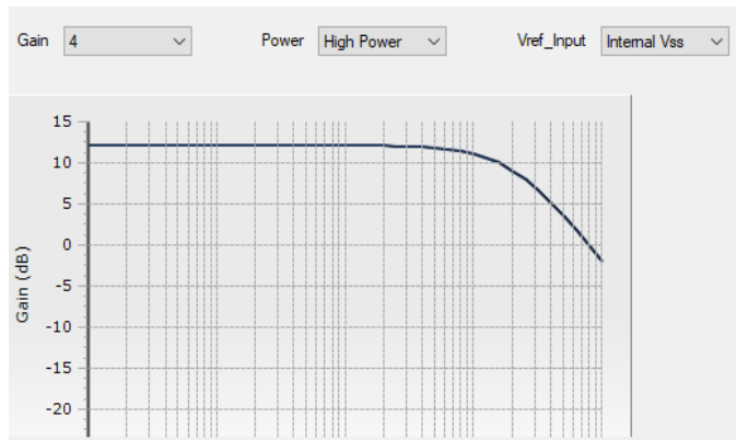
Figura 10 Configuración del amplificador de ganancia programable
